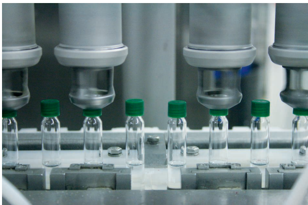
Automatisches Anbringen der Küvettenverschlüsse
