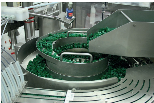
Vorbereitung der Küvettenverschlüsse in der Kontroll- und Sortiertrommel
