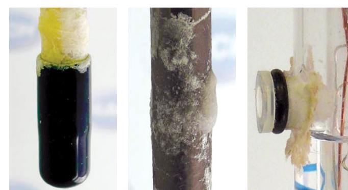
Unschädliche Kristallbildung an Lagerkappe, Elektrodenschaft oder Nachfüllöffnung
