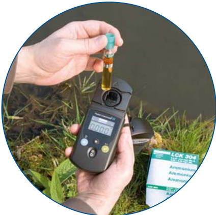
Abb. 7: Mobil draußen messen mit einem Knopfdruck: Das Einparameter-Messgerät POCKET Colorimeter II für Einsteiger.
