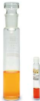
Abb. 4: Beim Küvetten-Test werden 90% weniger Chemikalien verwendet als im Titrationsverfahren.
